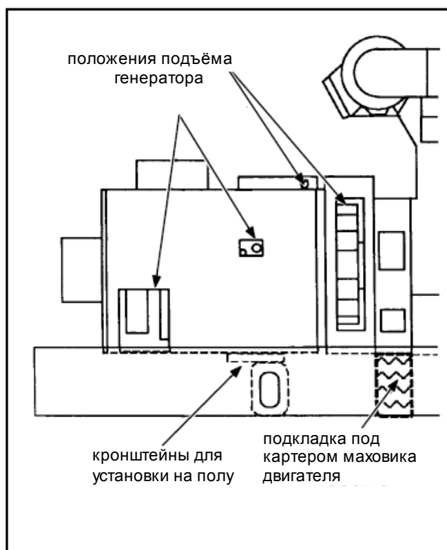
Рисунок 6-12. Положения подъема генератора
